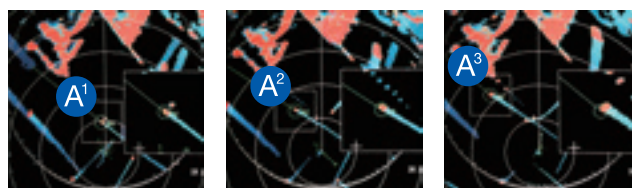
A/C Rain desactivado; imagen totalmente confusa por la perturbación de lluvia.
