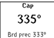
Après un virement de bord, le champ Head / Lift sur l'écran en bas à droite ou à gauche est remplacé par le dernier cap suivi sur ce bord (Last Tack). C'est à dire le dernier cap mémorisé en appuyant sur **ENTER**. Voir l'exemple illustré sur l'écran.
